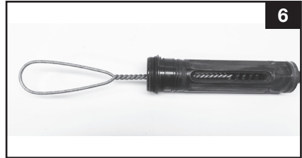
UTILISER LA BROsse POUR NETTOYER L'INTÉRIEUR DU BARREL
